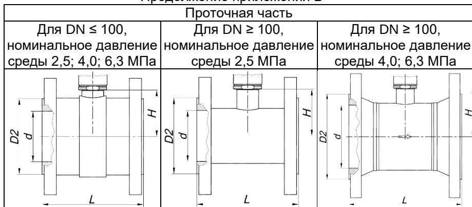
Рисунок Б.10 – Компактное исполнение расходомера (тип присоединения к процессу «фланцевый»)
