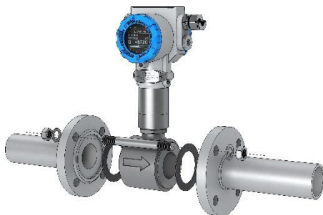
Рисунок 3.13 – Схема монтажа бесфланцевого (сэндвич) расходомера в трубопровод
